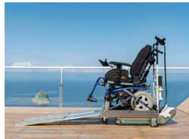
Fijar la silla de ruedas mediante las correas suministradas y vuelva a colocar las rampas telescópicas en las ranuras especiales.
